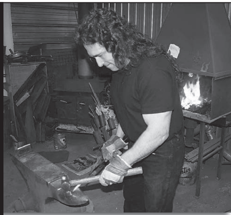
Rémy Bélanger chauffe, plie, étire et martèle les pièces de fer une à une selon les méthodes traditionnelles du forgeron.
